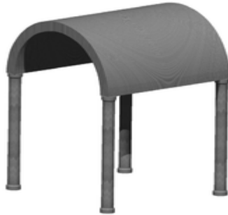
Bóveda de cañón
